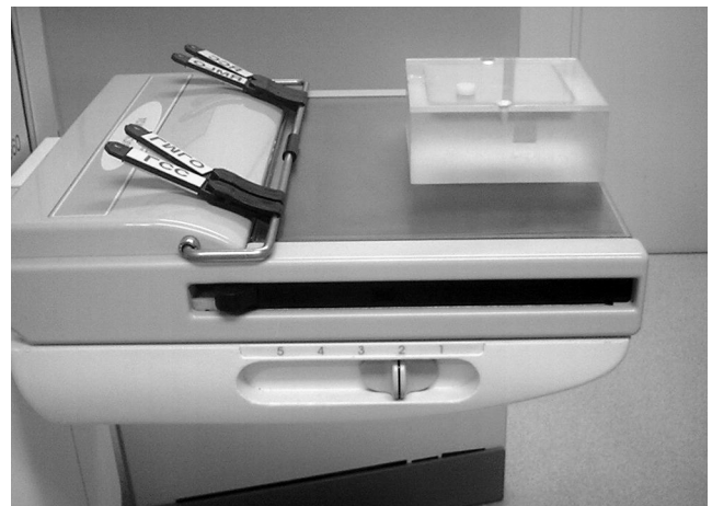
그림 4. 유방 팬텀은 카세트지지대 위에 위치하고 유방 팬텀의 흉벽쪽 경계를 수상면의 흉벽쪽에 오게 하고 좌우 중간에 놓는다. AEC detector가 중간(두번째)에 있는지 확인한다.
