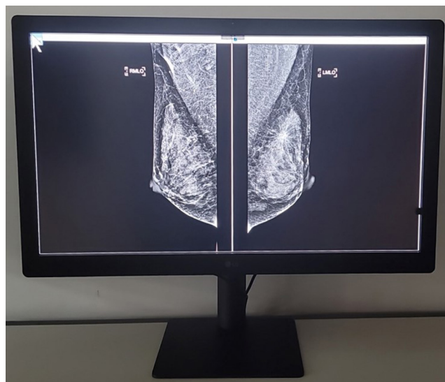
그림 3. 단일 8 MP 모니터 (LG 32HQ713D) 에 양측 내외사위 유방촬영술을 디스플레이 하여 영상간 이질성과 물리적인 공간의 벌어짐 없이 보여주고 있다.
